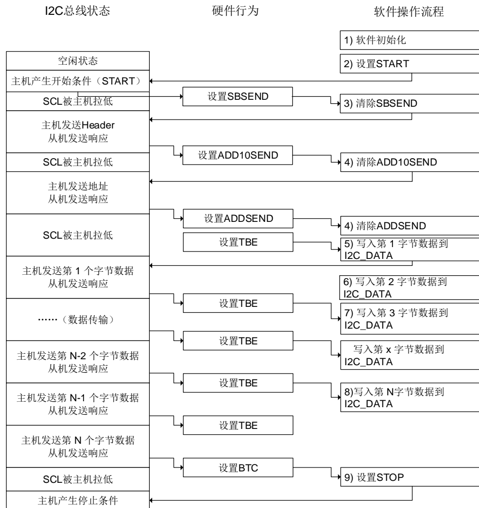
图 17-27. 主机发送模式（10 位地址模式）
