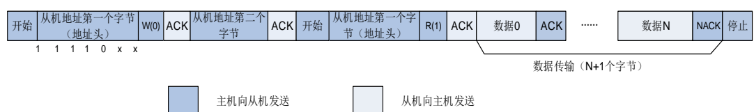
图 24-8. 10 位地址的 I2C 通讯流程（主机接收）
