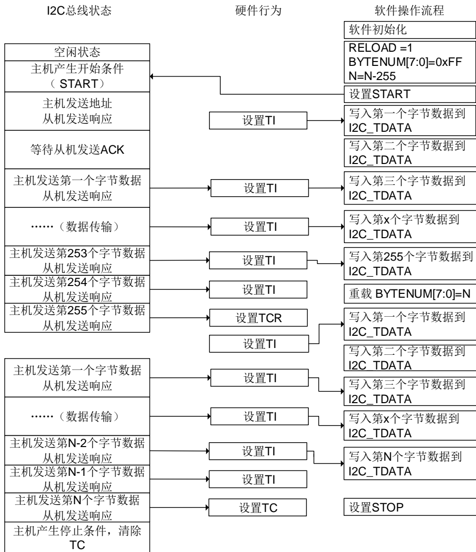
图 24-32. I2C 主机发送编程模型 (N&gt;255)
