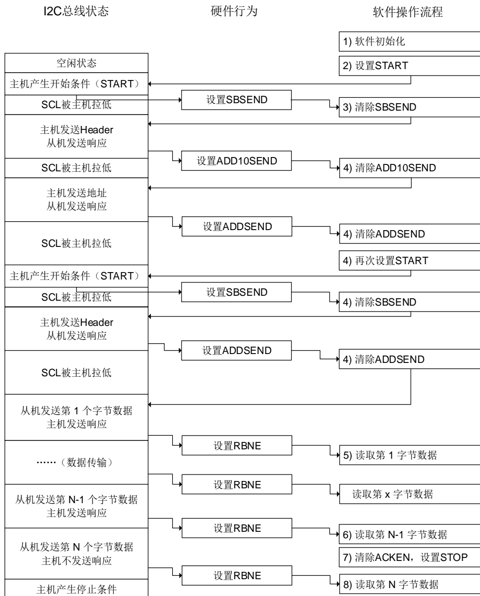
图 24-12. 主机接收使用方案 A 模式（10 位地址模式）
